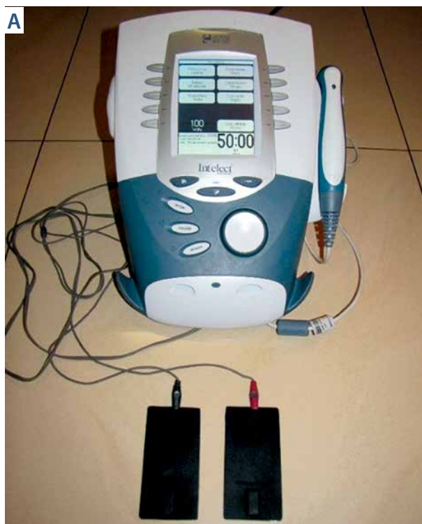
RYC. 2. Przykładowe elektrostymulatory do terapii ran. A – elektrostymulator wielofunkcyjny, B – elektrostymulator miniaturowy do użytku domowego
